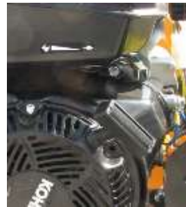
Drehzahlregelung unterhalb des Kraftstofftanks (oben) Starterzug (unten)
