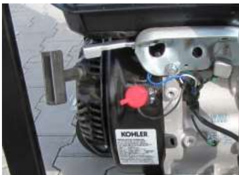
Starterzug – links, Drehzahlregelung – oben, Rundschalter für Start und Lauf – unten
