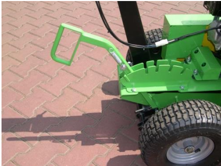
Schalhebel in der Stellung „aufgehoben“
