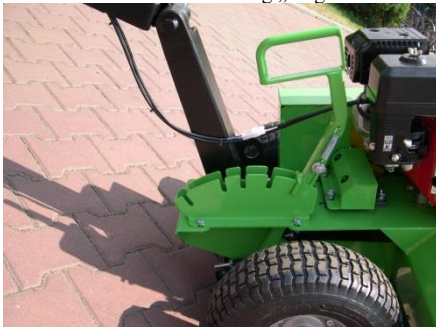
Schalhebel in der Stellung „max. Arbeitstiefe“
