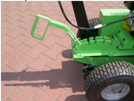
Schalhebel in der Stellung „aufgehoben“
