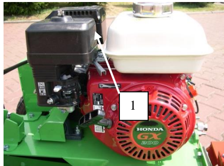
Luftfilter (1), unter Haube
