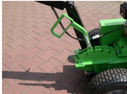
Schalhebel in der Stellung „min. Arbeitstiefe“
