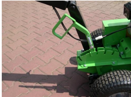
Schalhebel in der Stellung „min. Arbeitstiefe“
