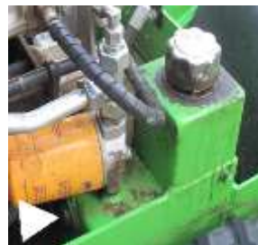
Hydraulikölbehälter mit Ölstandanzeiger
