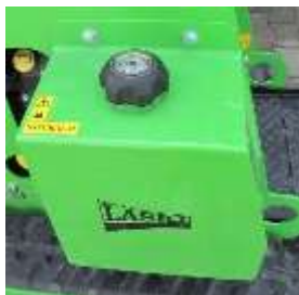
Kraftstoffbehälter mit Standanzeiger
