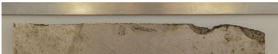
Ausbruch an der Schneide
