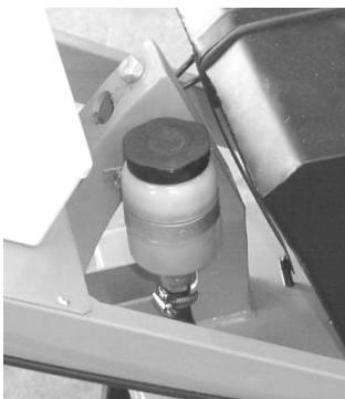
Ölstand in dem Ausgleichbehälter
