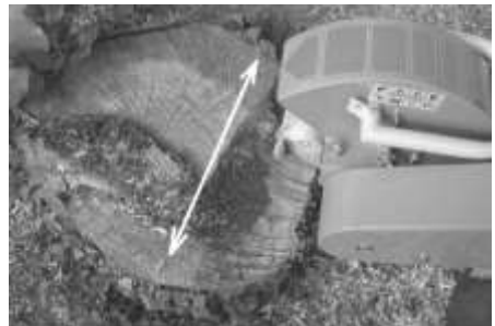
Spanabnahme durch schwingende Bewegung
